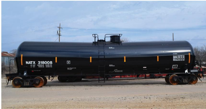
Este carro tanque de 31.800 galones (US) no enrollada y sin aislamiento ha sido diseñado con una carga ferroviaria bruto 286.000 libras para el transporte de petróleo crudo y otros líquidos inflamables. El carro está equipado con una escotilla de 20 pulgadas y ocho pernos de acero, y una válvula de alivio de presión McKenzie de 165 psi.
